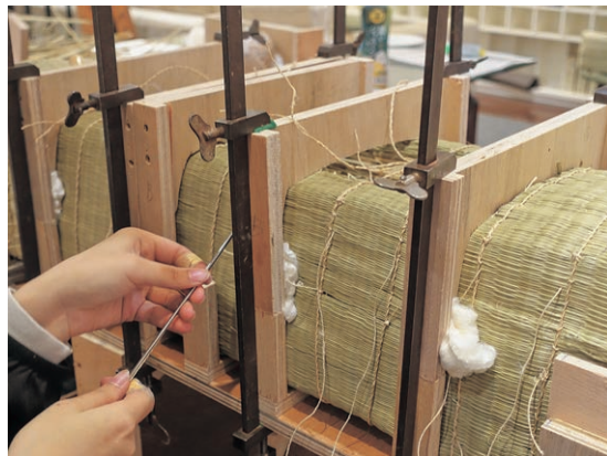
挿図34 中央7筋を縛り、土手差しを行う
