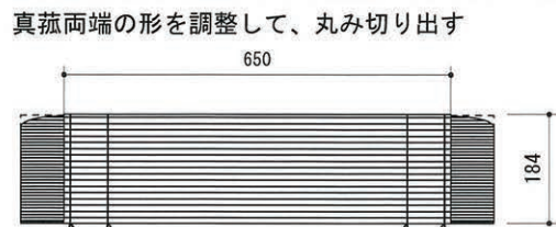
図3 模造品の製作設計図 (続き) ⑧~⑪
