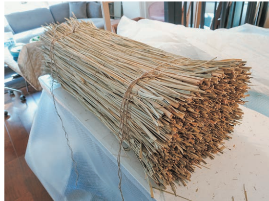
挿図26 直方体の芯材を作る
