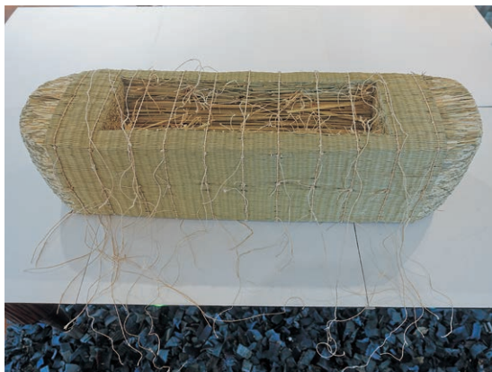
挿図35 2回目の土手差し後（全11筋）
