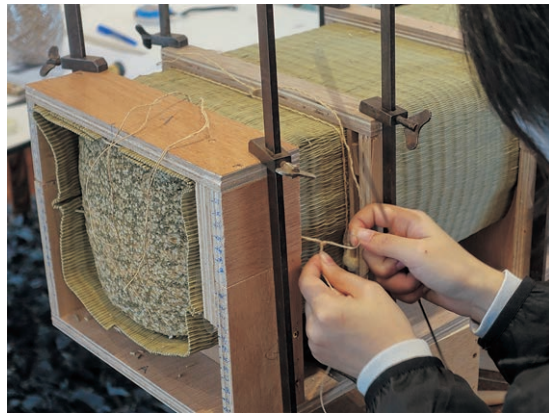
挿図32 各端2筋を縛り、2回目の土手差しを行う
