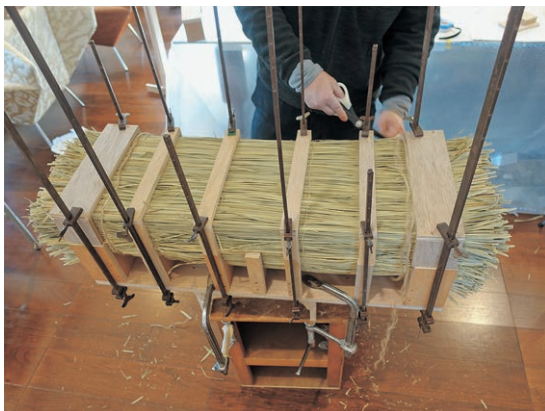
挿図27 木型とハタガネで芯材を圧縮する
