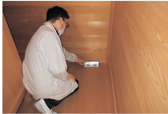
挿図4 箱型粘着トラップを使った害虫調査
