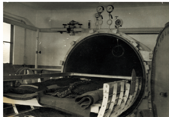
挿図5 燻蒸装置により宝物の燻蒸を行う様子 (昭和30年)
