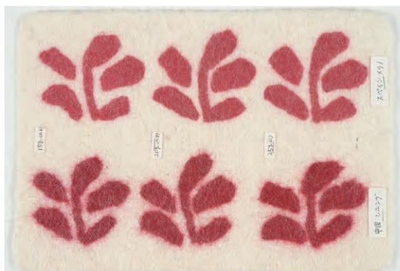
挿図56 プレフェルトの滲み方の比較 上はスペインメリノ、下は中国産シンニン（左から15g・20g・25g/各25cm×50cm）
