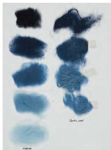
挿図59 5段階の藍染め見本（左：メリノ、右：シンニン）濃色ほど繊維が細くなる。すくも藍を使用（最濃色はハイドロを用いた化学建て）
