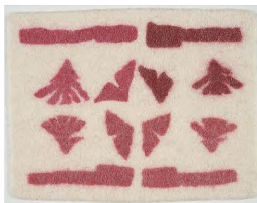
挿図58 繊維の細さによる滲み方の違い 左上から時計回りにスペインメリノ（20g/25cm×50cm）、オーストラリア産メリノ・ニードパンチプレフェルト（13g/25cm×50cm、800回ローリング）、トルコ羊（仔羊）の厚さ2種（15g/25cm×50cm、20g/25cm×50cm）
