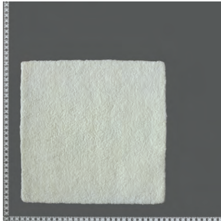
同 40 gの毛を40×40cmのシートから28分ローリングした結果 (26.8×27.3cm、縮絨率約67.5%)
