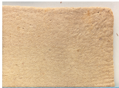
挿図377 同前 縁の裏面の様子 繊維が対角線に引張られる
