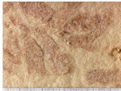
挿図265 同前 プレフェルトが地氈と十分絡んでいない様子
