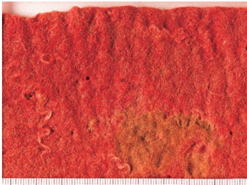
挿図346 北倉151 色氈 第3号 表層は赤色だが、虫喰箇所では芯層部が黄色に染まっている
