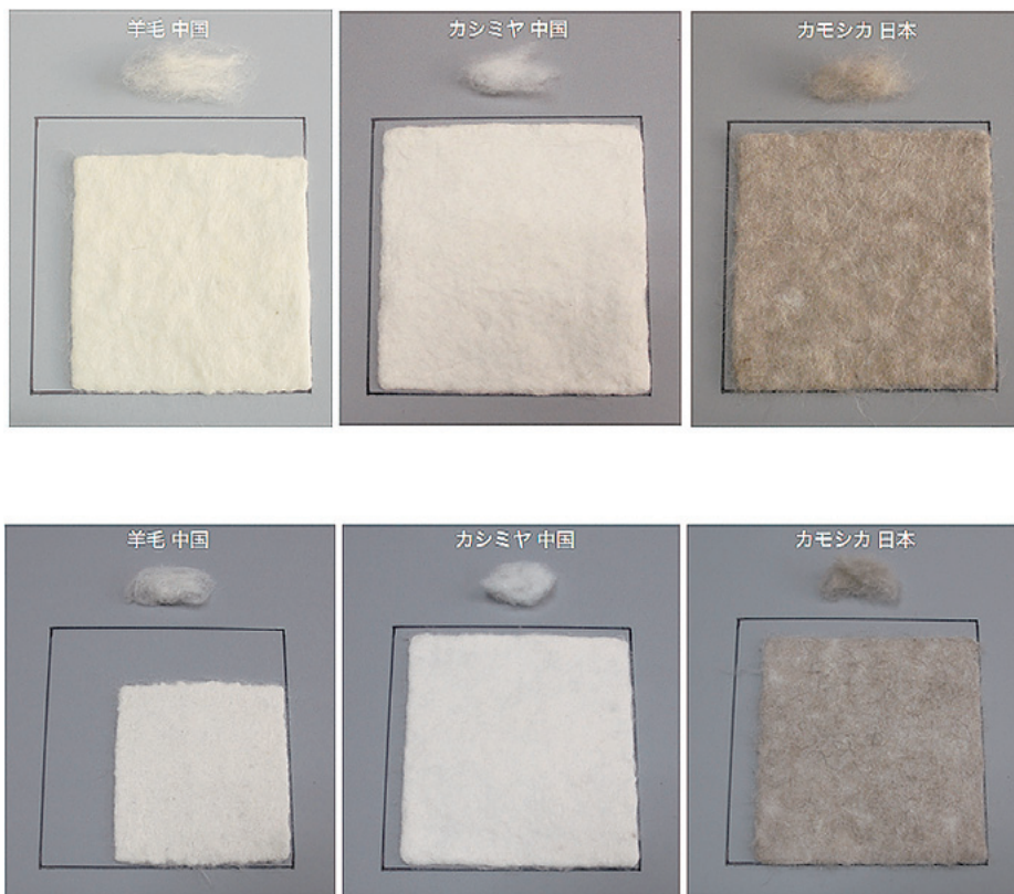
挿図451 中国産羊毛、中国産カシミア、日本産ニホンカモシカ毛による毛氈サンプル 縮絨条件：大きさ20cm×20cm 使用毛15g 縮絨時間12分（上段）20分（下段） ジョリー・ジョンソンによる試作
