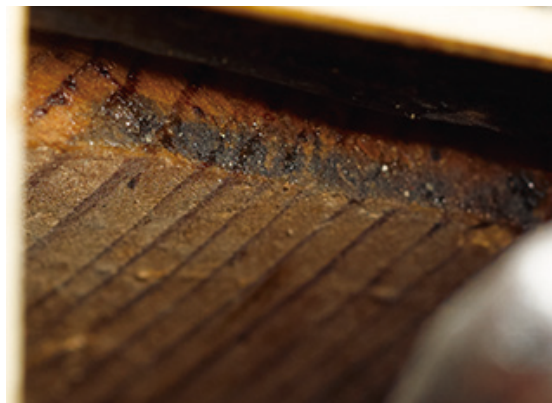
挿図6 同前 素地の木質小口に滲み出すヤニ様物質
