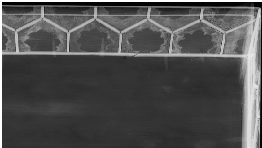
挿図43 同前 身 X線透過写真（部分） 木釘による接合
