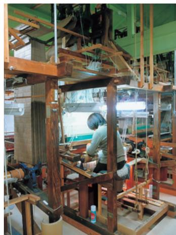
挿図46 ジャカードを取り付けた高機
