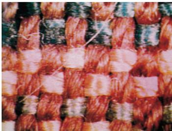
挿図28 第7条⑬ 縮緯が抜けている。
