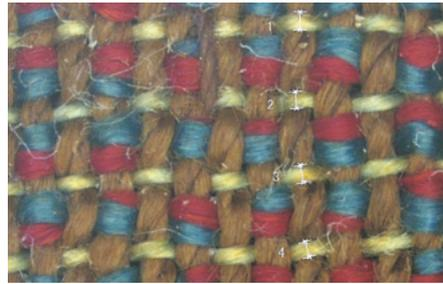
挿図32 7-61 締緯の直径 部分 (×7.5)
