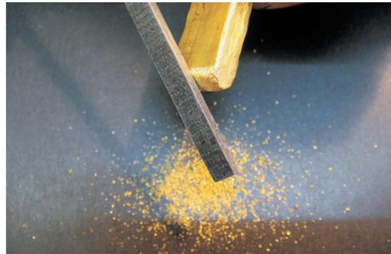
挿図17 金の塊を削って鑿粉を作る
