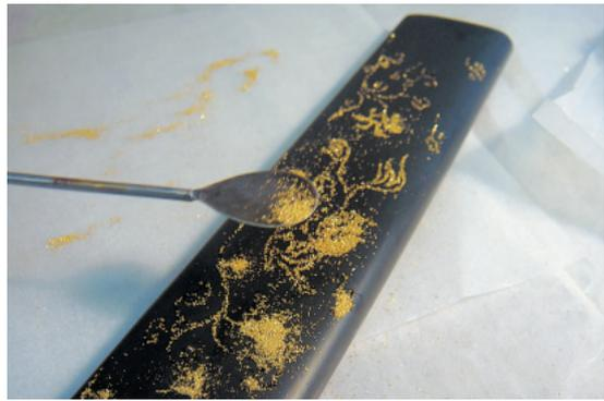
挿図31 粉匙で鍍粉を落とす (工程②)
