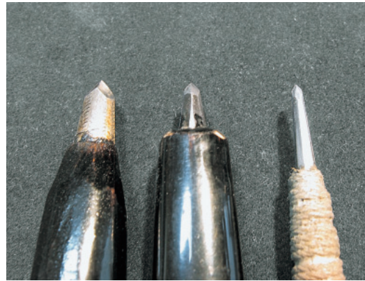
挿図20 毛彫に使用する刀 彫りたい線の大きさによって使い分ける
