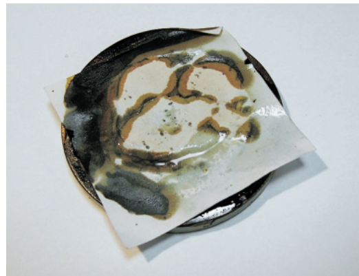
挿図15 樹脂地の試作③ 紙に仮貼りした貝を圧着する
