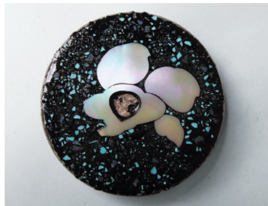
挿図19 樹脂地の試作⑩ 表面を低温で溶かし細かい研ぎ傷を消す
