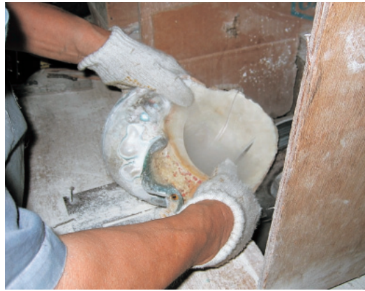
挿図48 丸鋸状の研磨切断機で貝を螺旋状に切り離す
