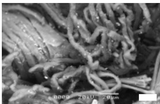
挿図18 中倉131 斑犀把漆鞘銀漆莊刀子2号 帶執 表 線維のよじれが有る（×750 SEM）
