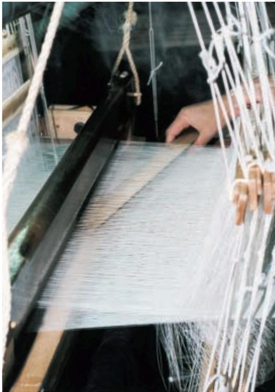
挿図26 経糸を刀杼で開口する
