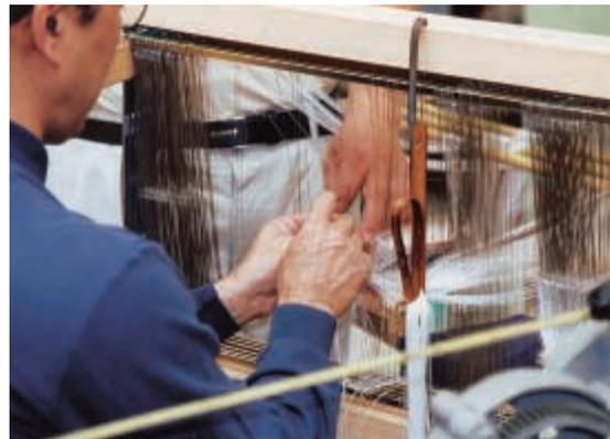
挿図88 枠綜絢に経糸を通す時、綾目の変化も一緒につくる
