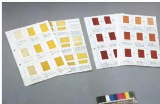
挿図10 草木材料で試験染めしたデータ
