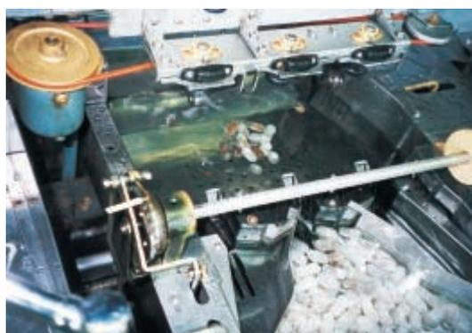
挿図5 自動繰糸機で製糸する
