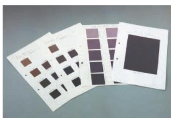
挿図56 紫根で試験染めしたデータ
