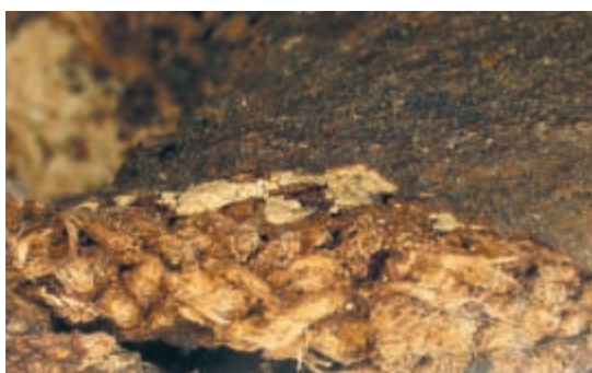
挿図6 南倉1 伎楽面 乾漆 第33号 下層から乾漆素地の麻布・白色下地・黒漆層 (×4)
