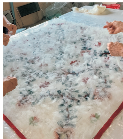
図版1-6 文様の上に地氈を細かく手で千切って振りかける
